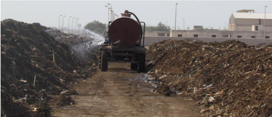
شكل (134): ترطيب الكومة بالماء للمحافظة على مستوى الرطوبة المناسب للنشاط الميكروبي
