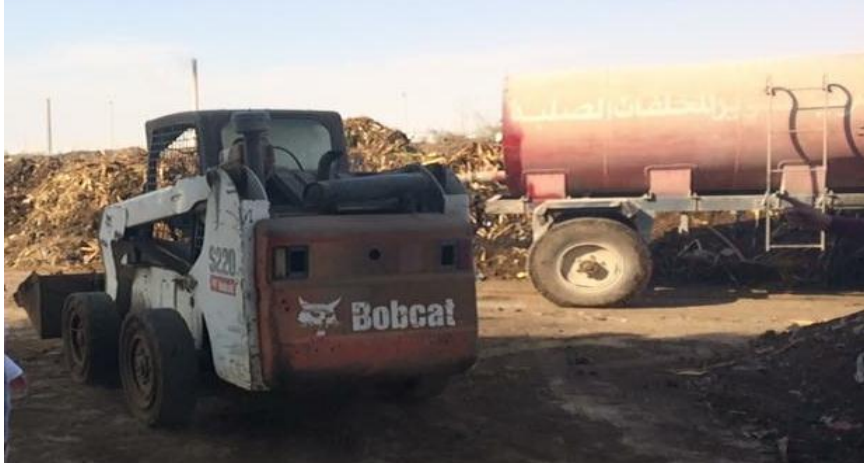
شكل (135): التقلب مع الترطيب اثناء فترة انضاج الكمبوست التي تستمر من 6-4 شهور
