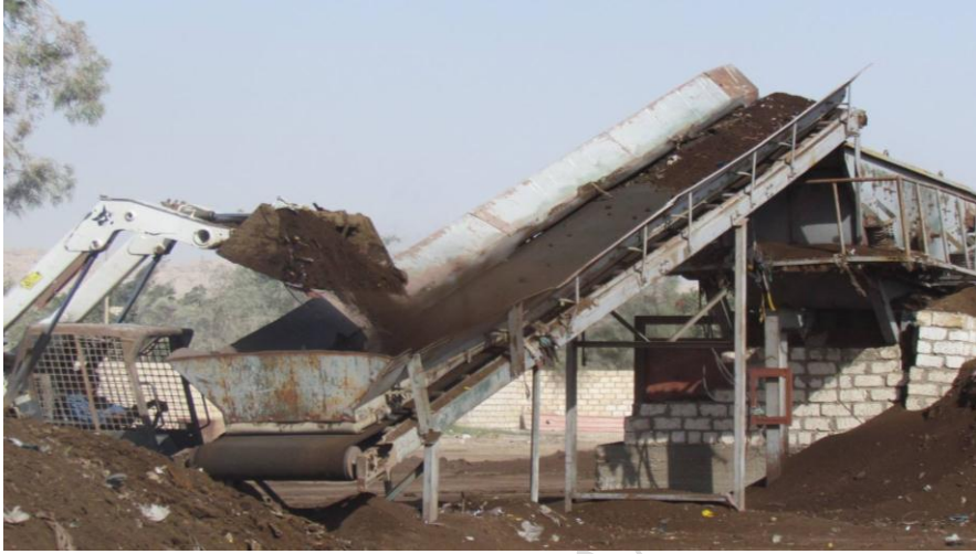
شكل (136): عملية الغربلة بعد نضج الكمبوست لازالة الحصى و المخلفات الكبيرة
